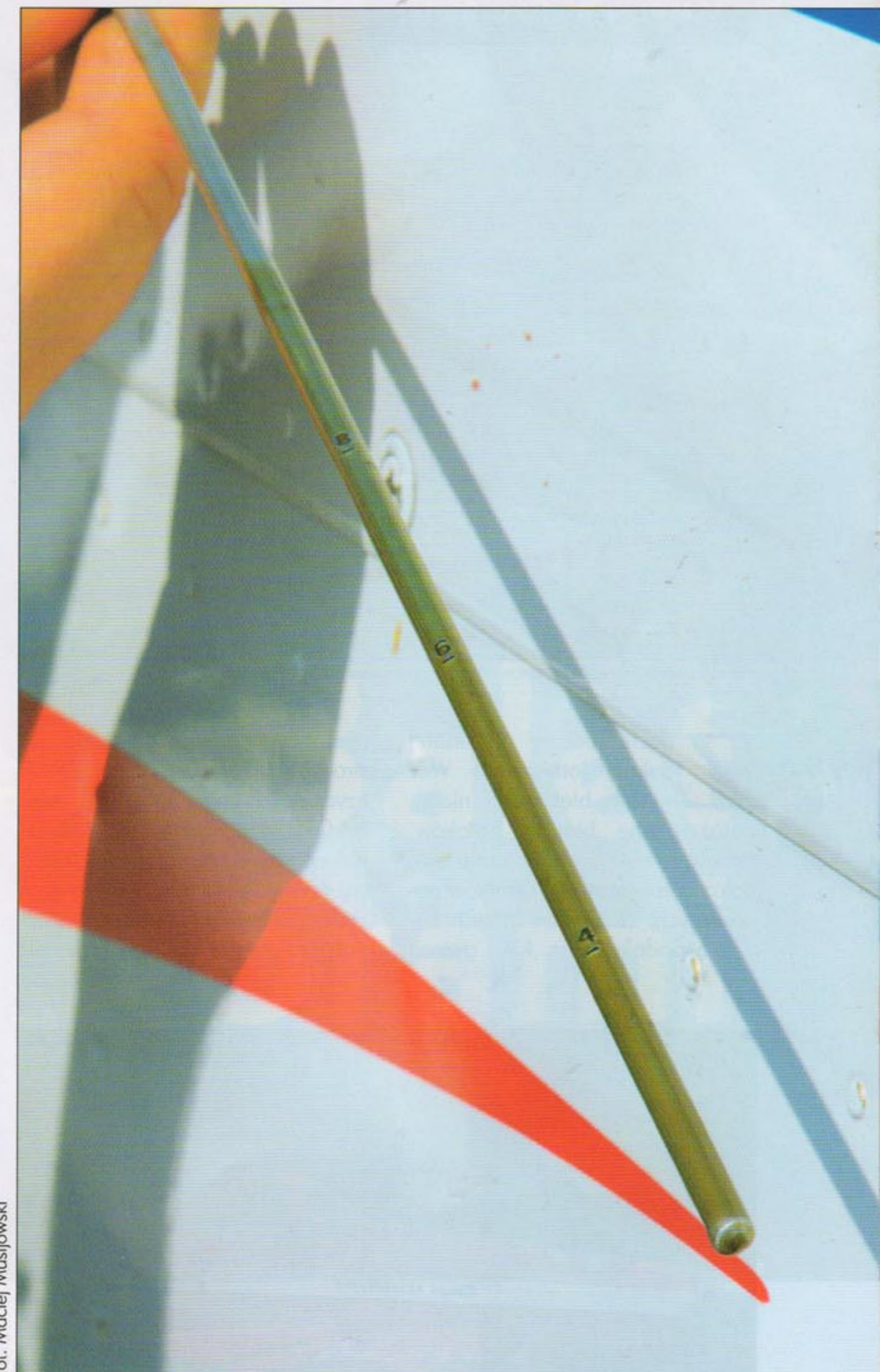
W wielu silnikach miarka oleju jest wyskalowana w kwartach (0.946 litra). Prawidłowa wartość wskazania jest podana w IUL
