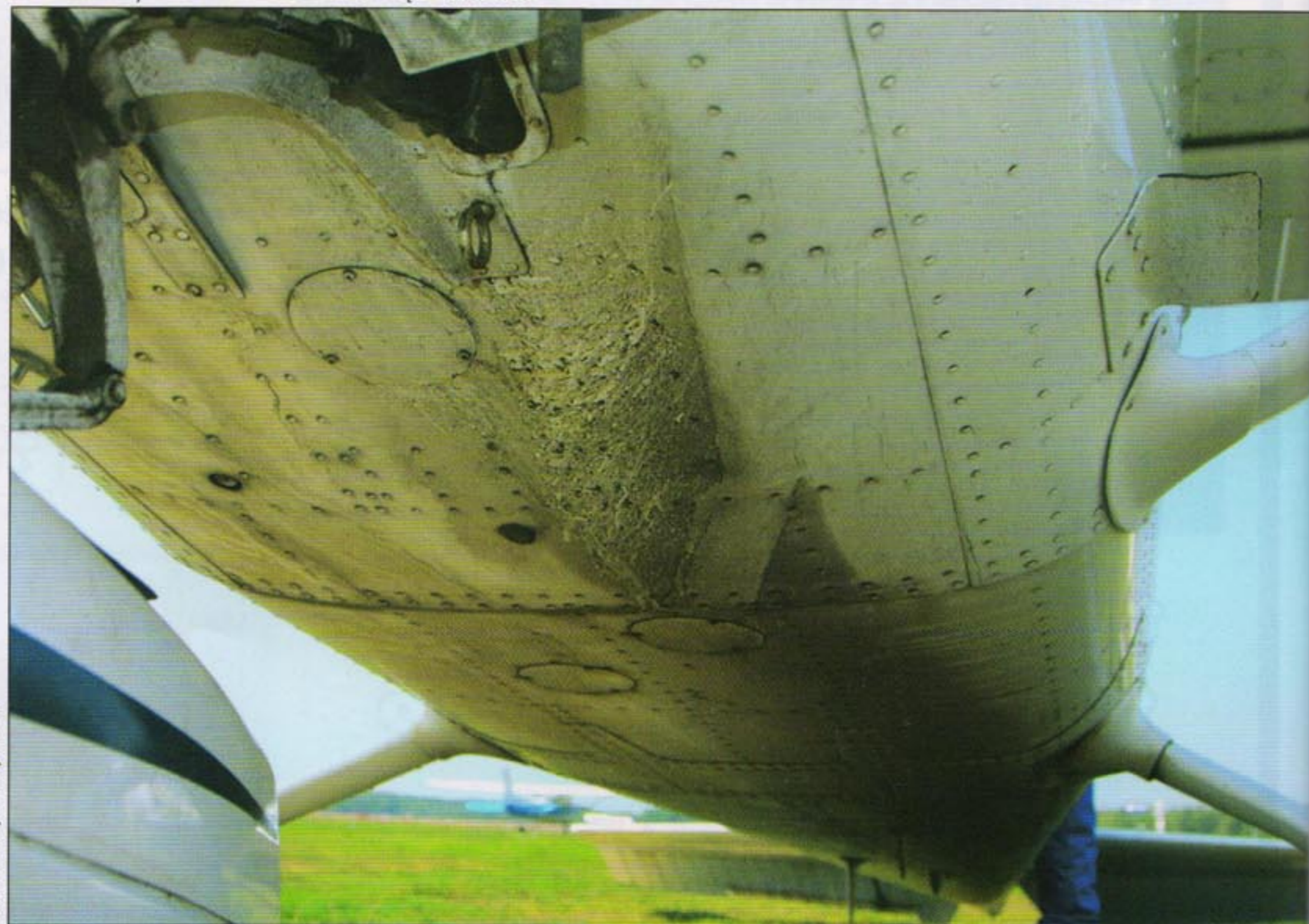
Nadmiar oleju w silniku widać na zewnątrz samolotu
