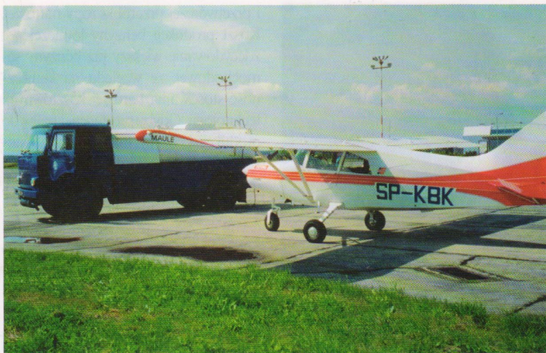
Tankowanie samolotu z cysterny-dystrybutora lotniskowego
